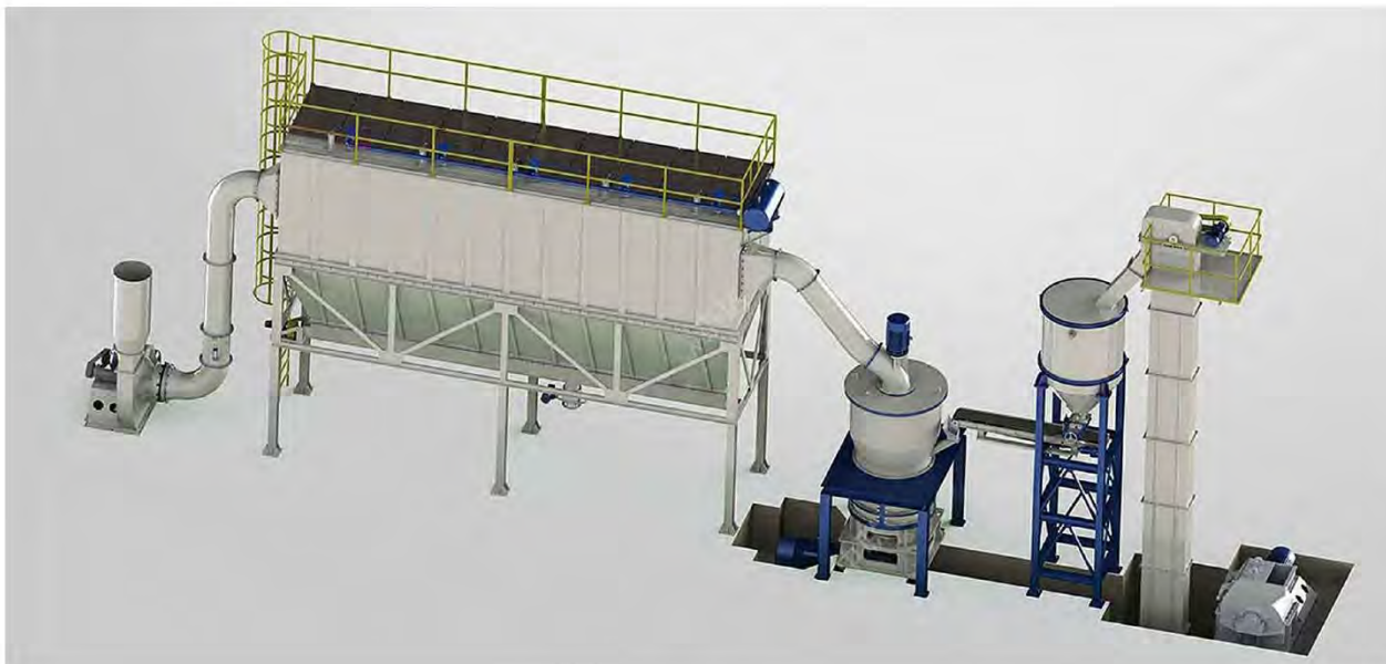
Sistema de Moagem de Argila ESC.: 1:200
