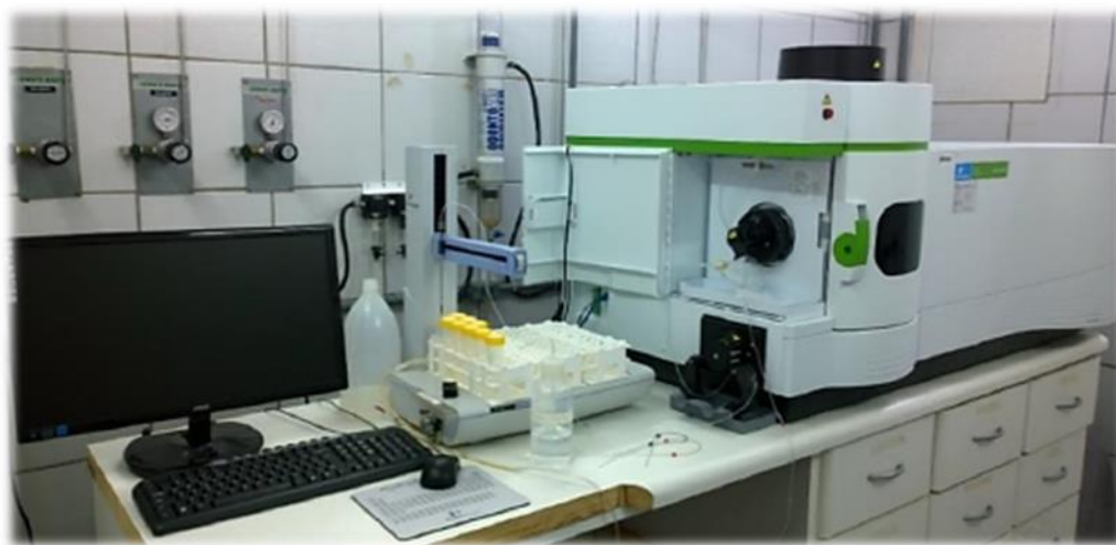
Figura 4: Equipamento ICP-OES marca Perkin Elmer, modelo Optima 8300 com amostrador automático modelo S10 utilizado para as determinações dos elementos-traço.
