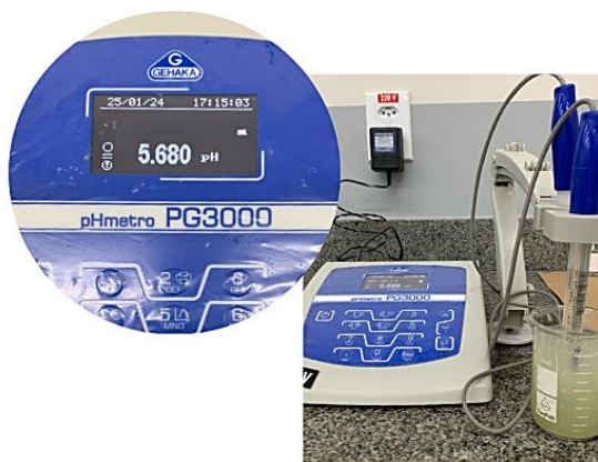
Figura 5: Peagâmetro digital de mesa Gehaka PG3000.
